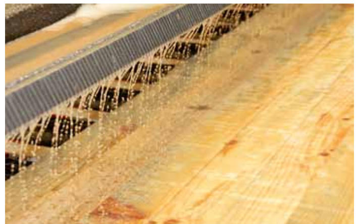
Besonderheit in der L3-Stapelanlage: Die Palettenware wird im Durchlauf imprägniert
