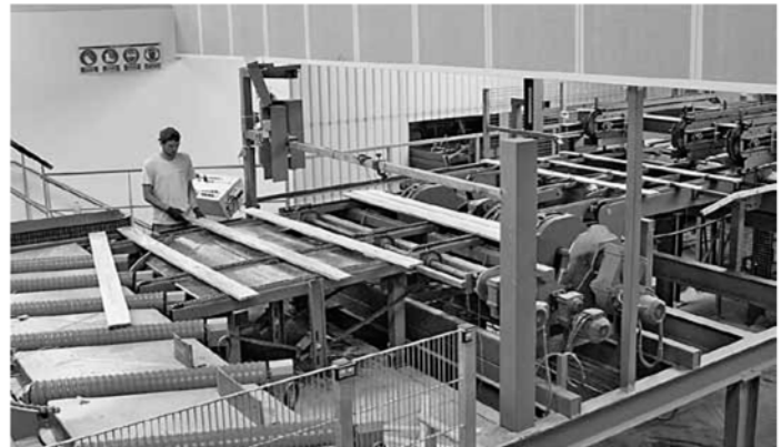
Die Seitenware – bis zu vier Bretter pro Stamm – gelangt direkt zu zwei Stapelmaschinen von Kallfass
