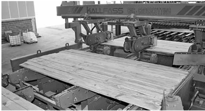
Lagenweise Zuführung zur Cross-Cutting-Säge bei der Hauptwarensortierung L3 von Kallfass
