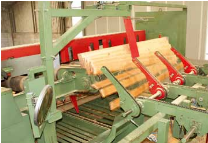
Hier beginnt der Kallfass-Part: Abzug der Palettenbretter, aufgetrennt mit der CSMK 285-A1 von Linck
