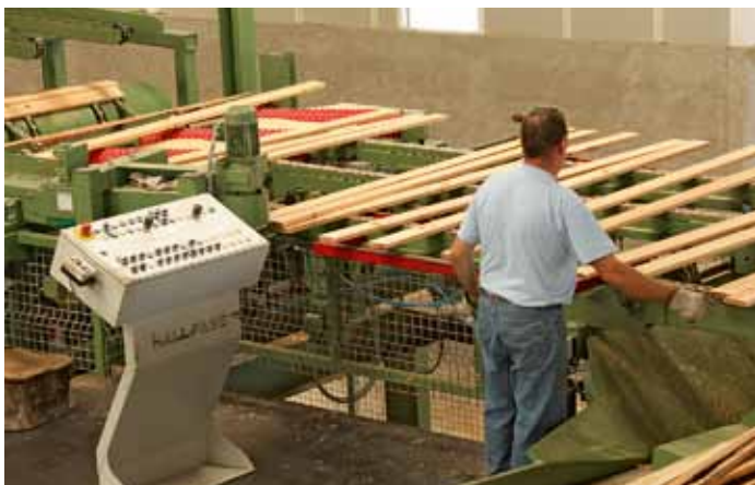
Die Hauptware gelangt am Querförderer vereinzelt zum Mitarbeiter und wird beurteilt
