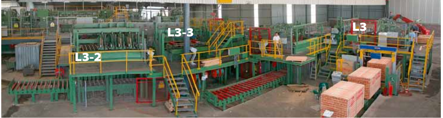
Komplexe Kallfass-Sortierung in Portugal: Sortierung der Kanthölzer (L3-2), jene für mindere Hauptware (L3-3) sowie die Hochleistungsanlage L3 (v. li.)
